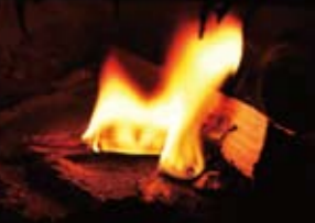
松煙焚き 細かく切った松をゆっくり燃やすことで、 煤が生じる。
