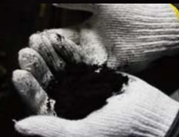
煤とり作業 とったばかりの煤は空気を含むため、ふわふわしてとても軽い。
